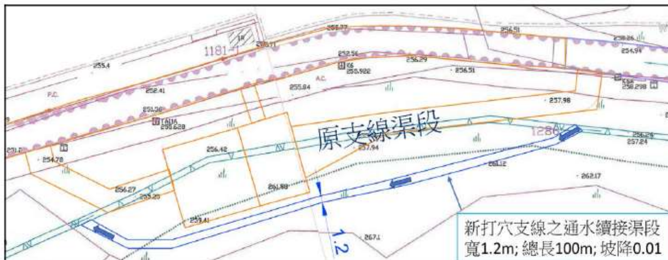
打穴支線通水設施遷移續接渠段
