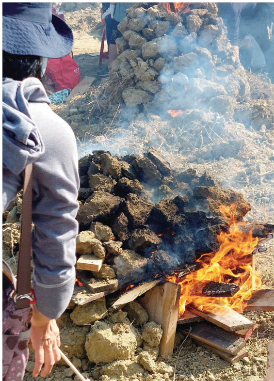
木頭構築的窯口正在燃燒，一會兒就會崩塌
