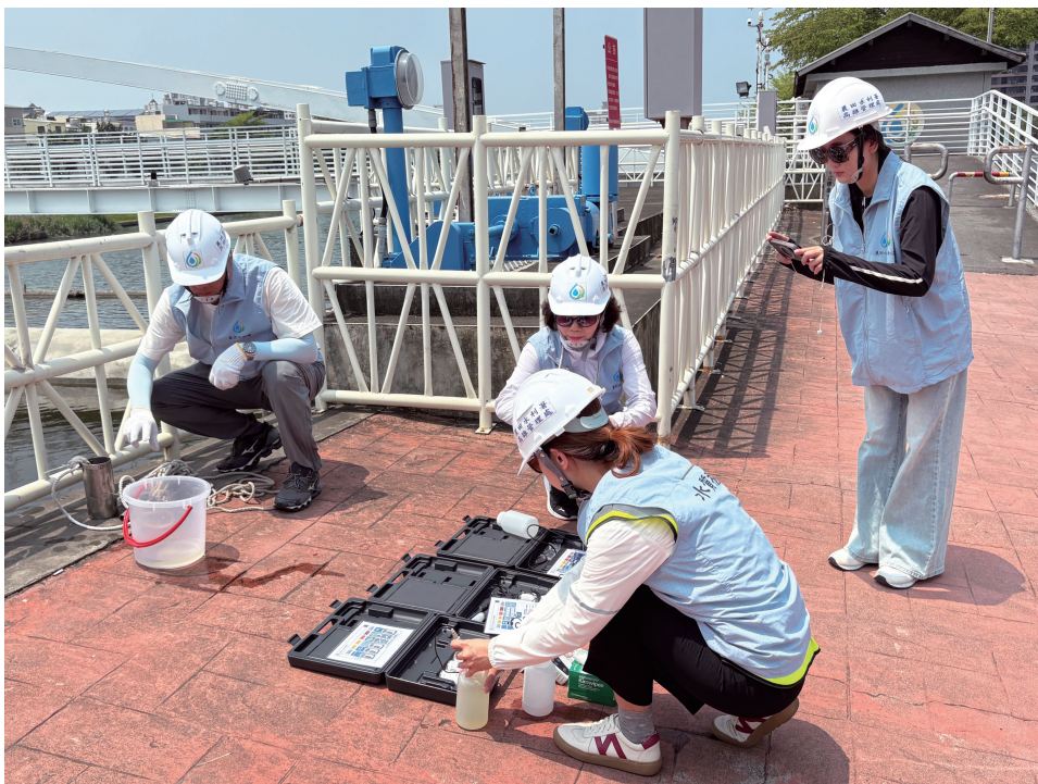
圖 4 實地演練現場水質採樣及檢測
