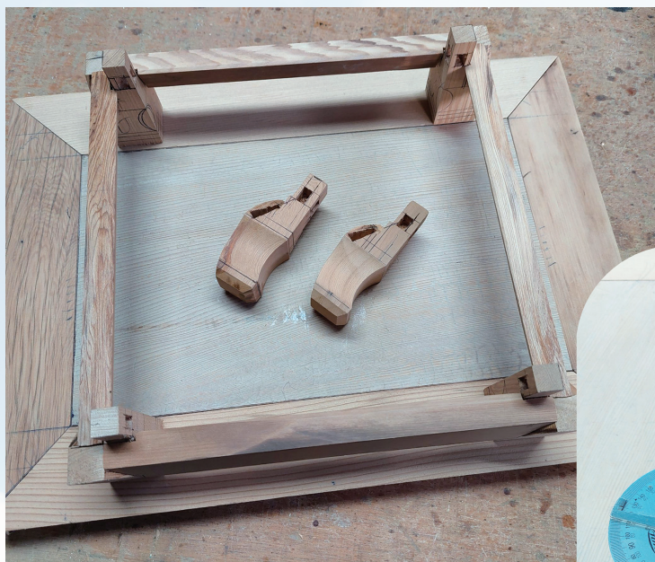
左上 俗稱「香焦腿」的「鼓腿彭牙樺」 右中 量角器丈量精確角度後，進行電鋸製程 下 木工方孔鑽台，貫穿樺洞之用
