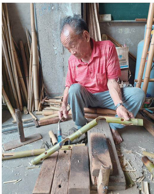
過去用木屑生火烤竹彎曲，現在改用瓦斯噴槍
